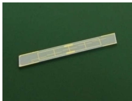
10 \mu\text{m} 厚度铌酸锂薄膜调制器 (硅基底、钛扩散波导)
